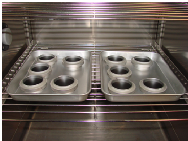
図 3.7 透湿度測定試験状況例 (恒温高恒湿槽内)
