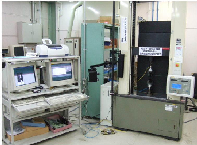
図 3.9 精密万能試験機(オートグラフ AG-5000C)型
